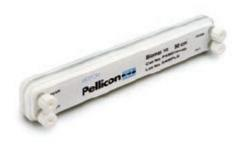
К установке LabScale подсоединяются кассеты Pellicon XL 50 площадью 50 см². Фильтрующий материал заключен в неразъемный полипропиленовый корпус. Удерживаемый кассетой объем составляет 3,2 мл. Pellicon XL обладает линейной масштабируемостью, т.е. параметры процесса могут быть пересчитаны для работы на кассетах Pellicon с большей площадью фильтрации.
